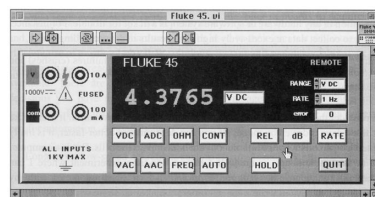
図1 Fluke45デジタルマルチメータの実物と仮想計測器
